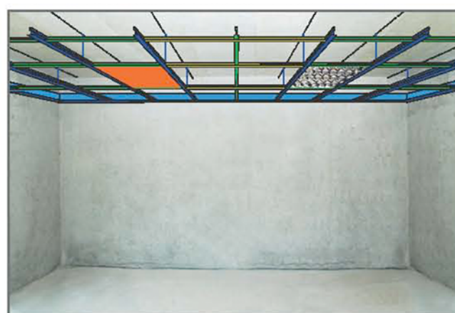
8. Schéma osadenia protipožiarného krytu na zabudované svetidlo Krycia doska je pripravená nad podhľadom
